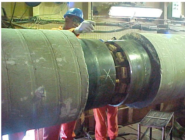
FOTO 8.5.2-2: Dutos com capa de concreto
