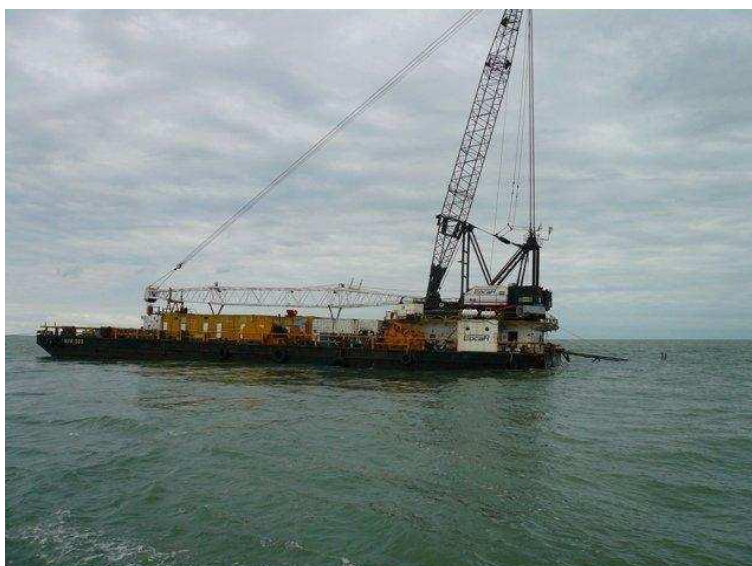
FOTO 8.5.2-3: Embarcação utilizada para soldagem dos tubos
