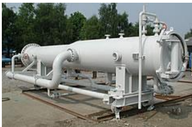
FOTO 8.3.8.1-1: Figura ilustrativa lançador e receptor de pig ( scraper )
