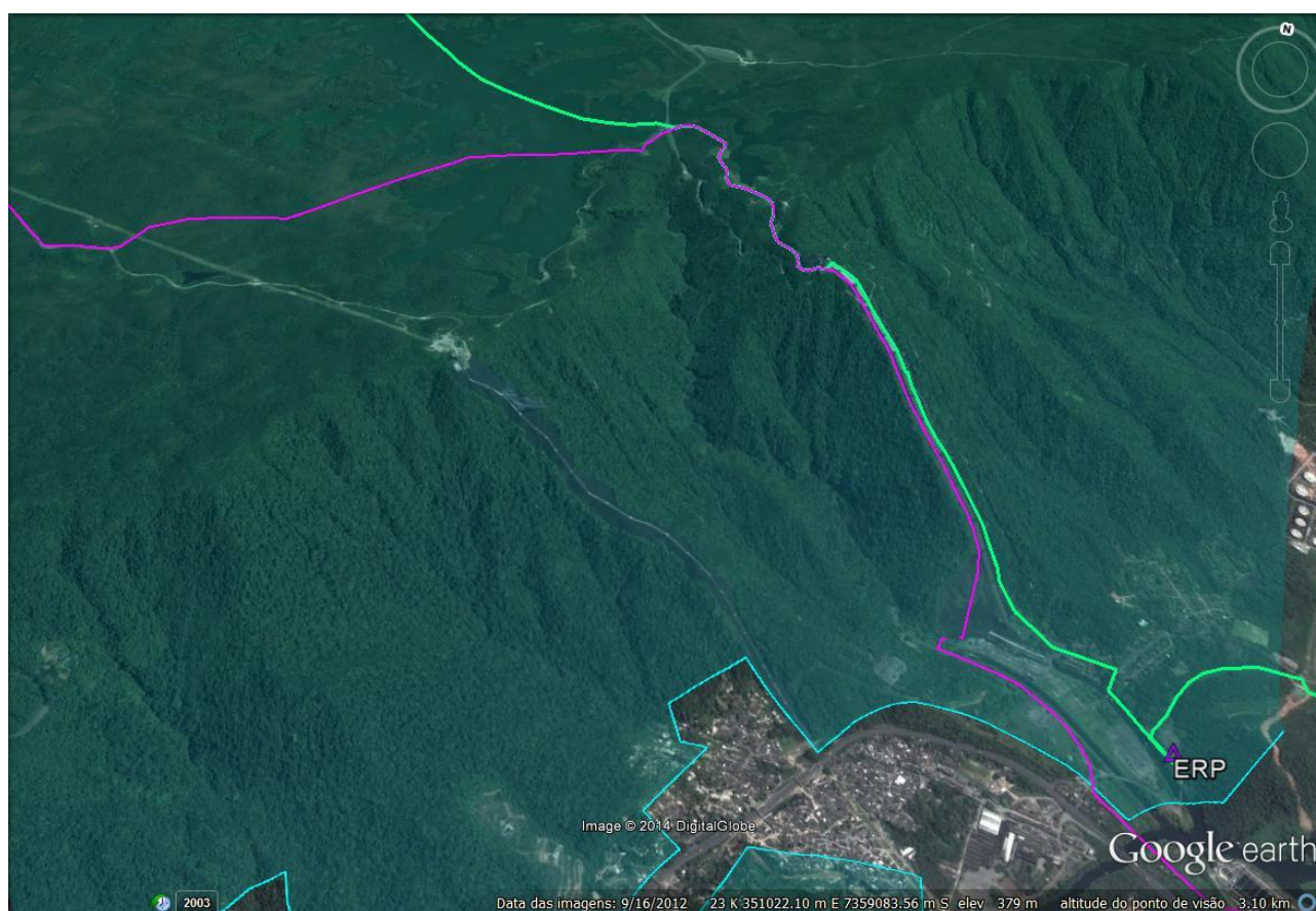
FIGURA 7.2.3.1.3-14: Traçado do Projeto Logum Trecho Paulínia – RMSP - Santos (linha verde) no trecho de descida da Serra do Mar. A dutovia seguirá paralela aos dutos de água da Emae, a leste, até atingir a Estação Redutora de Pressão (ERP). A diretriz Projeto Uniduto (traço cor magenta) contemplava a descida por esse trecho da Emae, mas pelo outro lado da faixa de dutos existente. A área em verde indica a incidência do Parque Estadual da Serra do Mar (PESM).
