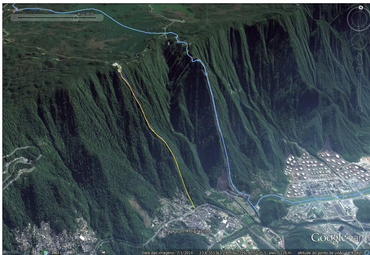
FIGURA 7.2.2.2-1: Detalhe do trecho de descida da Serra do Mar indicando pelo traço azul o traçado do Projeto Logum – Trecho Paulínia – RMSP - Santos, que contempla o compartilhamento da faixa de dutos da Emae. O traço em amarelo indica a faixa de dutos da Petrobras
